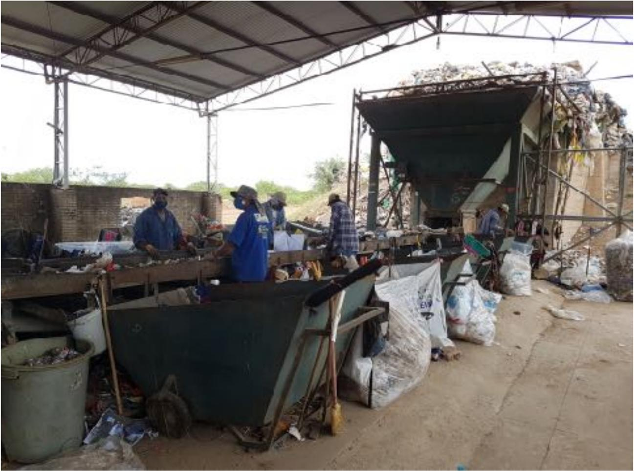
*En la imagen se aprecia el embudo y la cinta mecánica a través de la cual los residuos se transportan para separarlos manualmente.*
